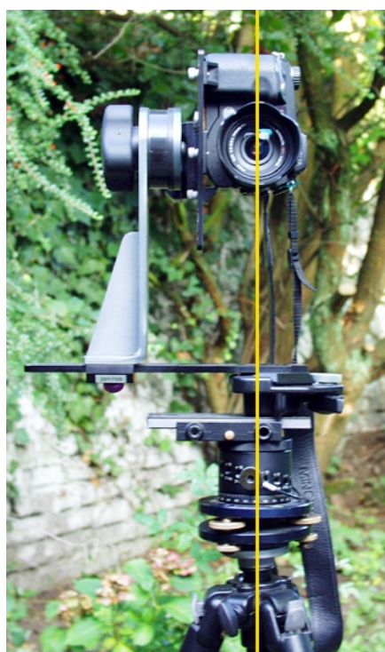
Le centre de l'optique et l'axe de rotation de la rotule se trouvent sur une même ligne verticale.
